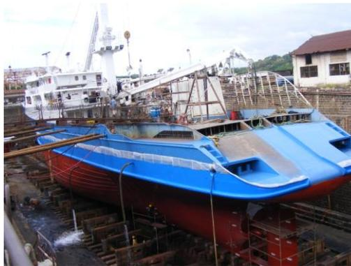
La peinture est un moyen de protéger les tôles ou aciers contre les corrosions marines. Les couches de peintures les plus utilisées sont le primer, l'anticorrosive et l'antifouling. Les modes d'application sont soit au pinceau, rouleau ou au pistolet.
