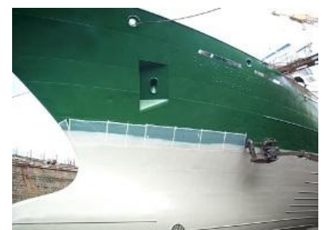
Photos : application peinture silicone après sablage.
