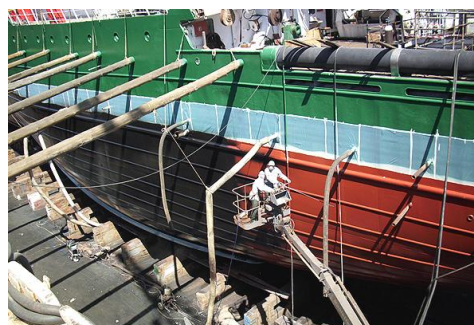
Photos : application peinture silicone après sablage.
